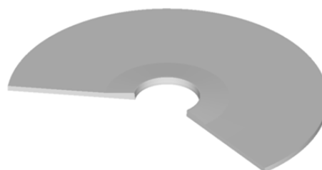
Рис. 4. Заготовка в розрізі після пробивання перемички
